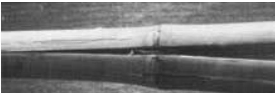
*Fig. 5. Rottura per taglio.*
