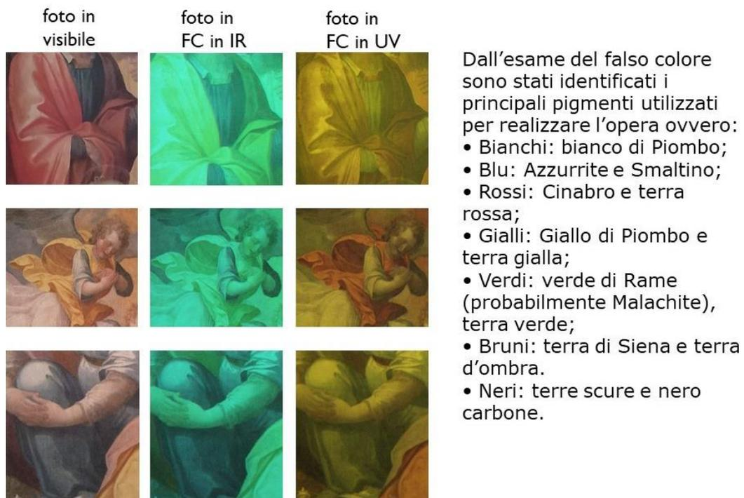
Fig. 40. Dettagli in visibile, in FCUV, in FCIR e identificazione dei pigmenti utilizzati
