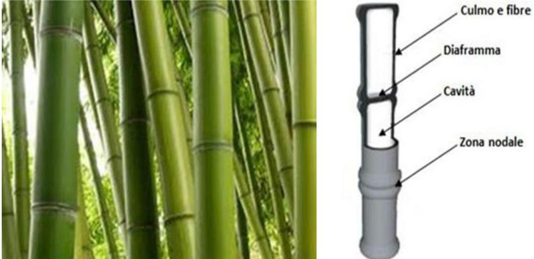
Fig. 3. Sezione longitudinale della canna.
