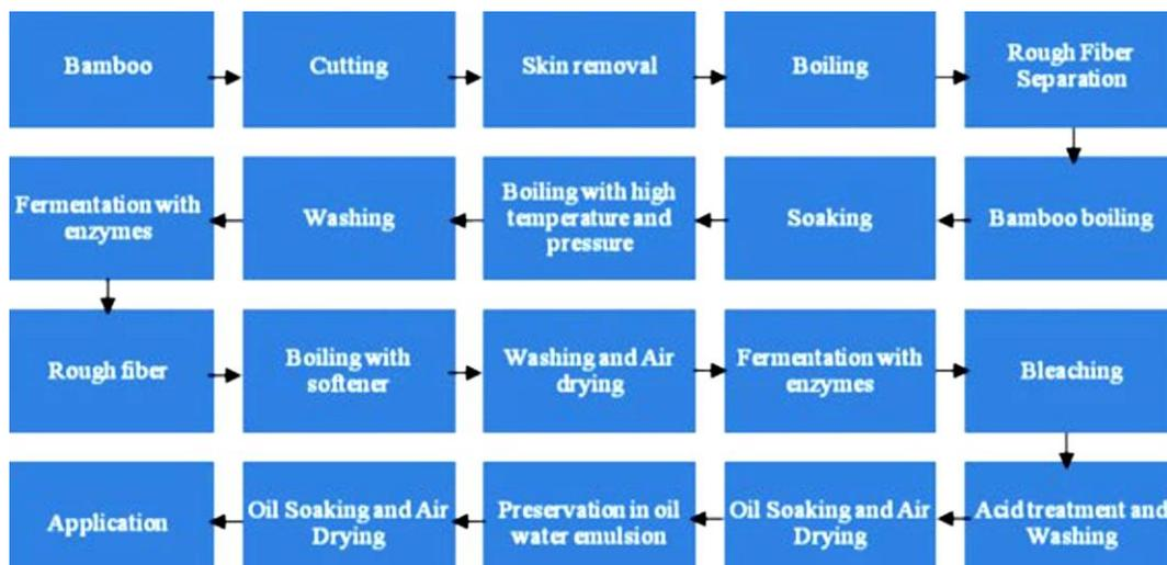
Fig. 7. Lavorazione della fibra di bambù
