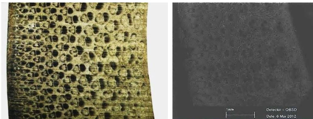
Fig. 2. Micrografia elettronica al microscopio (a) e a scansione (b) di una sezione trasversale di bambù, che mostra le variazioni di microstruttura dal bordo interno a quello esterno. Fonte: Nurdiah (2015).
